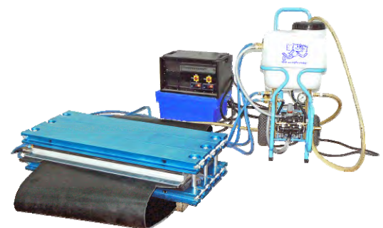
Вулканизатор с гидроподушкой 1,100 x 525 мм с высотой траверсов 70 мм; Блок распределения питания с фазой проверяется с помощью UIP Контроллера MLT 7000 и централизованного Контроллера за процессом MLT 6214 для тканевых лент (давление 8 бар)
