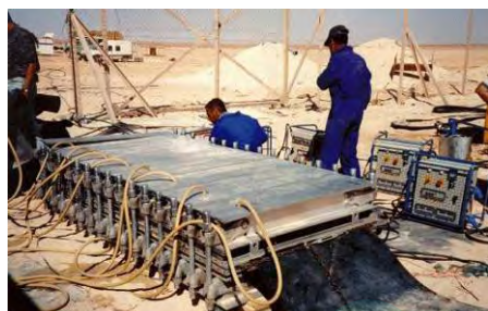
Стыковка тросовых лент Требуемое давление на поверхность: 12-14 атм.
