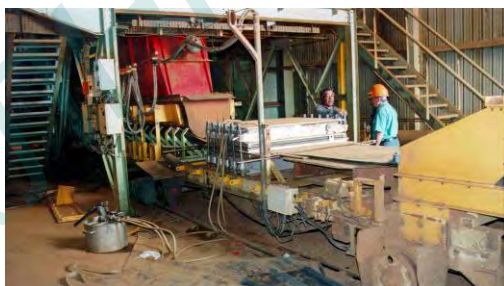
Стыковка монотканевых лент Требуемое давление на поверхность: 7-10 атм.
