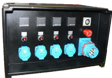
Блок распределения питания для управления Pt100 с стандартными контроллерами. С одним выключателем дифференцированного тока (ВДК) и одним автоматическим выключателем для каждой фазы, фазы проверяются через 3 светодиода или UIP контроллер MLT 7000; аварийная кнопка; поворотный переключатель Автоматический / Ручной / Выкл, 4 Электронных контроллера + 1 таймер на 4 нагревательных плиты с Pt100
