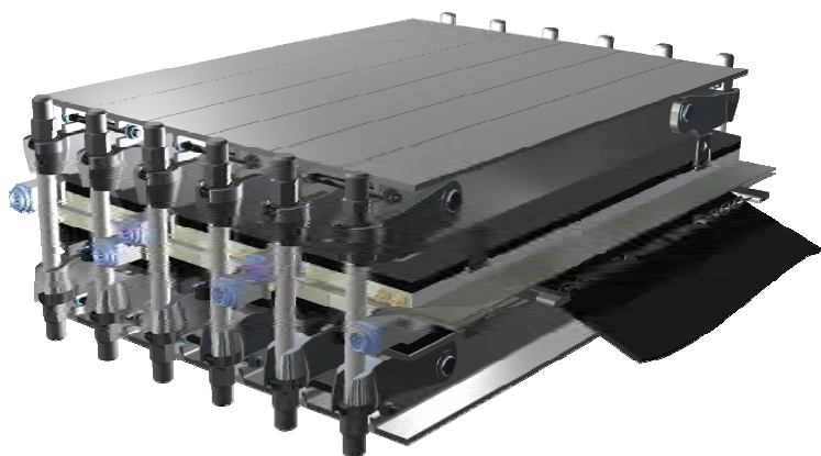
Пресс до 15 атм.(для тросовых и тканевых лент)
