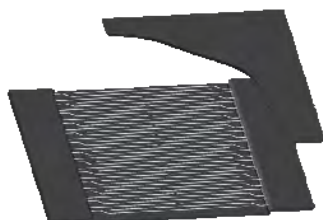
Стыковка тросовых лент Требуемое давление на поверхность: 12-14 атм.
