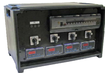
Блок распределения питания для управления. С одним ВДТ и одним автоматическим выключателем для каждой фазы, проверяются через 3 светодиода или UIP контроллер MLT 7000; аварийная кнопка; поворотный переключатель Автоматический / Ручной / Выкл, 4 Электронных контроллера + 1 таймер на 4 нагревательных плиты с Pt100
