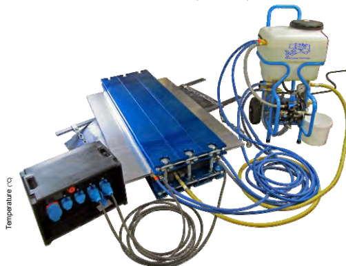
Блок распределения питания для управления. С одним ВДТ и одним автоматическим выключателем для каждой фазы, проверяются через 3 светодиода или UIP контроллер MLT 7000; аварийная кнопка; поворотный переключатель Автоматический / Ручной / Выкл, 4 Электронных контроллера + 1 таймер на 4 нагревательных плиты с Pt100
