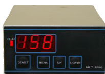
Электронный контроллер MLT 1006 с мембранной клавиатурой и цифровым дисплеем, светодиод для "Включения нагрева" Контроль температуры со встроенной функцией таймера
