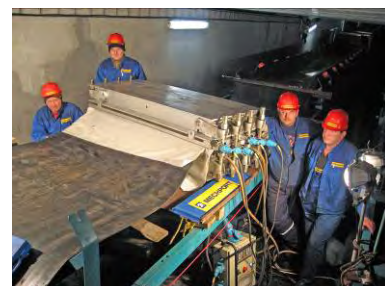
Стыковка кордовых лент Требуемое давление: 4-10 атм.
