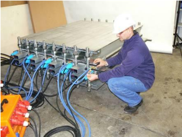
Насос может обеспечивать охлаждение до 14 нагревательных плит (расход до 20 л/мин).
