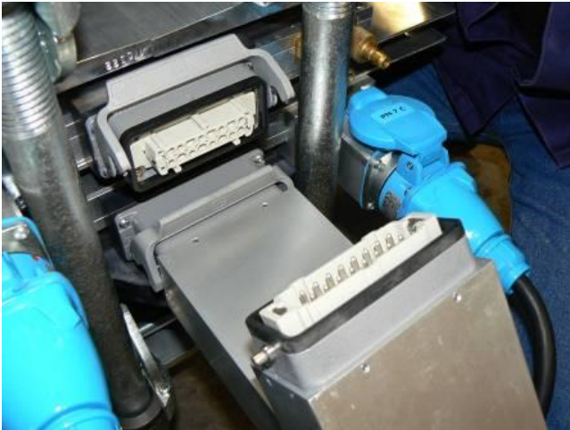
Подсоединить электронные регуляторы к верхним нагревательным плитам.
