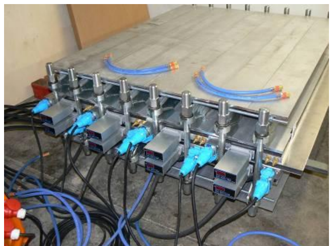
При более чем 4 нагревательных плитах, всегда объединяются 2 нагревательные плиты.
