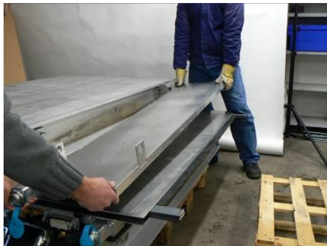
Наложить верхние нагревательные плиты параллельно нижним нагревательным плитам.
