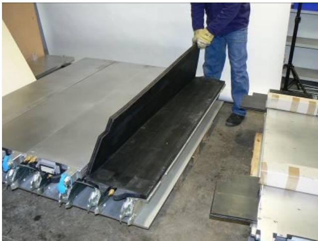
Положить изоляцию на подушки давления.
