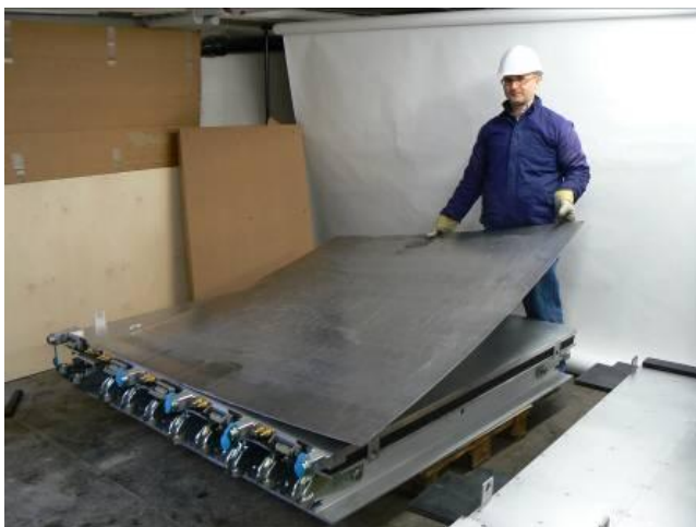
Наложить нижнюю алюминиевую прижимную пластину.
