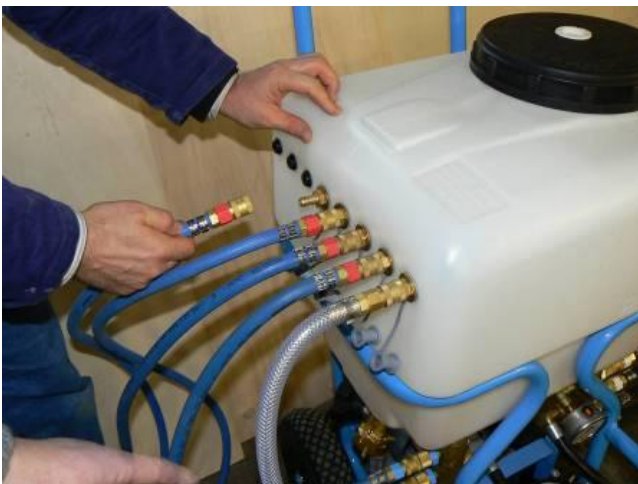
Присоединить выводы для рециркуляции (возврата) воды (красное кольцо).
