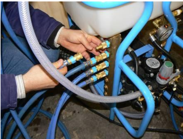
Присоединить все выводы для водяного охлаждения (синее кольцо).
