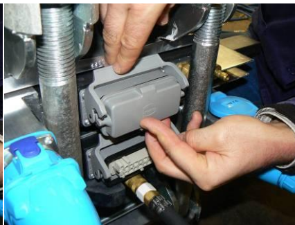
Надеть на штекерные колодки защитные колпачки
