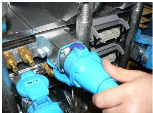
Проверить блокировку вытягиванием.
