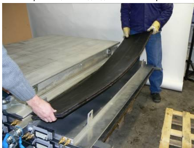
Установить верхние изолирующие пластины на нагревательную плиту между направляющими накладками и штепсельным разъемом.
