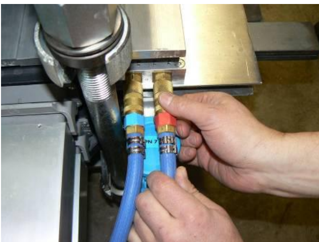
Проверить вытягиванием плотность соединения.
