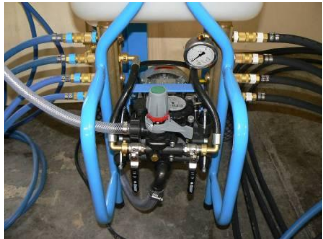
Левая шина распределителя: выводы для водяного охлаждения. Правая шина распределителя: выводы для подушек давления Waterbag.
