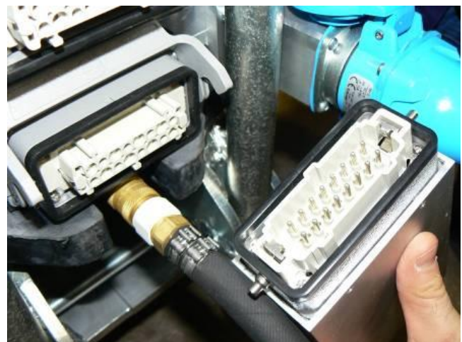
Подсоединить электронные регуляторы к нижним нагревательным плитам.
