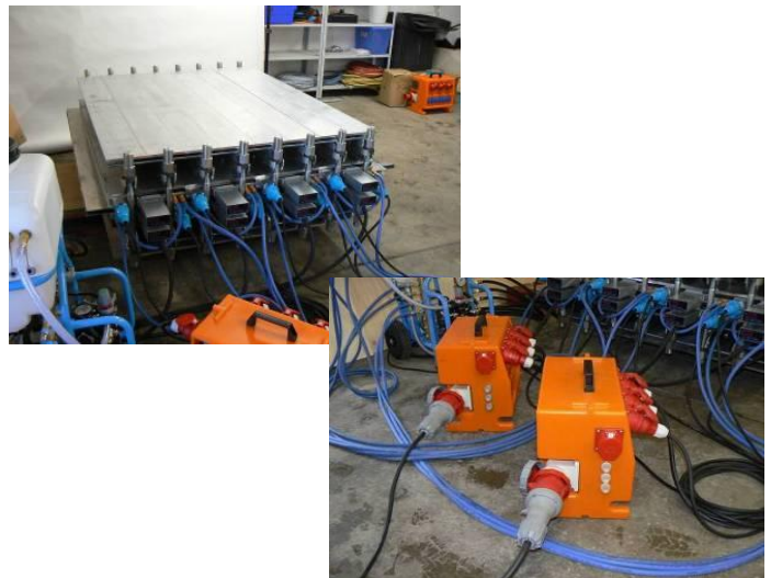
Еще раз проверить, все ли подключено и убедиться в наличии всех фаз (должны гореть 3 светодиода).
