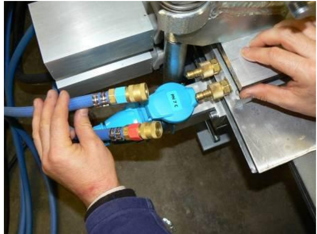
Присоединить шланги для водяного охлаждения.
