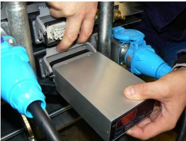
Проверить фиксатор легким вытягиванием.
