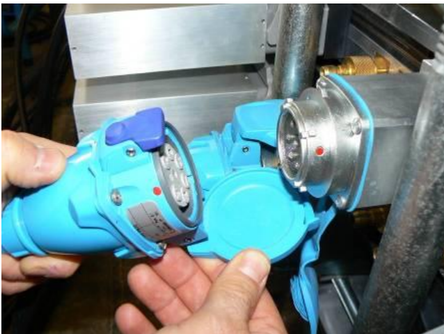
Открыть синие соединительные муфты для нагревательных плит.
