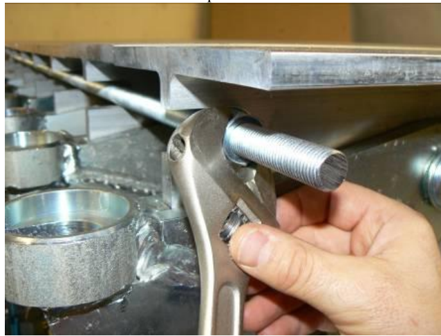
Установить в верхние и нижние траверсы винтовые стержни ф 16 мм и затянуть.
