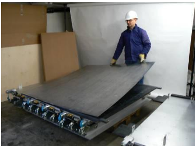
Наложить верхнюю алюминиевую прижимную пластину.
