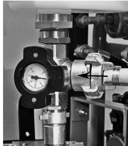
Внимание: при более чем 2 нагревательных плитах, насос должен быть снабжен пресной водой или должен быть присоединен дополнительный бак с водой. Иначе, нет достаточного охлаждения.
